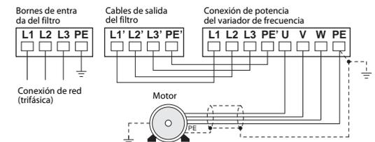
Los cables entre el convertidor de frecuencia y el motor deben apantallarse con el fin de reducir las radiaciones parásitas. El apantallamiento del cable del motor se debe ejecutar extensamente por el lado del convertidor de frecuencia. Para las condiciones ambientales y para la posición de montaje hay que observar las indicaciones del manual de instrucciones del variador defrecuencia FR-D700.
