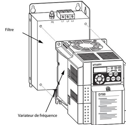
Vissez ensuite l'unité composée d'un filtre et du variateur de fréquence sur l'embase de montage de l'armoire électrique à l'aide de vis adaptées (non fournies). Afin d'obtenir une action du filtre optimale, il est nécessaire que le boîtier du filtre antiparasites et l'embase de montage mise à la terre soient ensembles conducteurs. Cela est normalement réalisé en vissant les filtres sur la plaque de montage.
