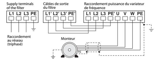
Le câble entre le variateur de fréquence et le moteur est blindé afin de réduire les émissions parasites. Le blindage du câble moteur doit être largement dimensionné côté moteur et côté variateur de fréquence.
