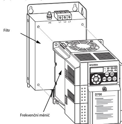
Tato jednotka zahrnující filtr a frekvenční měnič se nyní vhodnými šrouby (nejsou součástí dodávky filtru) přišroubuje na montážní desku rozvaděče. Aby se dosáhlo optimálního filtračního účinku, je nezbytné, aby byl kryt VF odrušovacího filtru elektricky vodivě spojen s uzemněnou montážní deskou. To se obvykle zajišťuje sešroubováním filtru s montážní deskou. V případě potřeby odstraňte nátěr na odpovídajících kontaktních místech.
