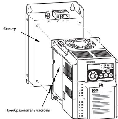
После этого блок, состоящий из фильтра и преобразователя частоты, следует закрепить подходящими винтами (не входящими в комплект фильтра) на монтажной панели распределительного шкафа. Для достижения оптимального фильтрующего действия необходимо, чтобы корпус фильтра имел электропроводящее соединение с заземленной монтажной панелью. Как правило, это соединение образуется через винты крепления фильтра на монтажной панели. Если необходимо, удалите эмаль в соответствующих местах монтажной панели.
