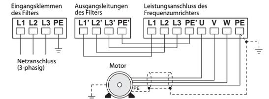
Die Leitung zwischen Frequenzumrichter und Motor ist zwecks Reduzierung der Funkstörstrahlung geschirmt auszuführen. Der Schirm der Motorleitung ist motor- und frequenzumrichtersseitig großflächig aufzuliegen.
