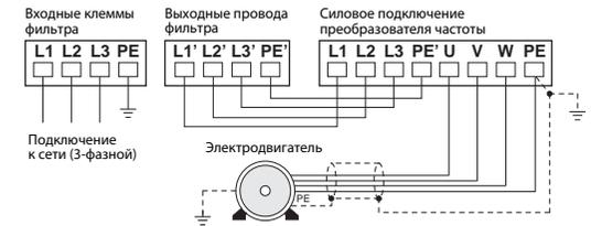
Для уменьшения излучения помех провод между преобразователем частоты и двигателем должен быть экранированным. Экран провода двигателя следует заземлить как со стороны двигателя, так и со стороны преобразователя частоты, при этом поверхность контакта должна быть как можно больше. В отношении окружающих условий и местоположения необходимо соблюдать указания руководства по эксплуатации преобразователя частоты FR-D700.
