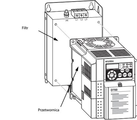
W celu zamontowania zespołu filtr - falownik na płycie montażowej rozdzielnic użyj odpowiednich śrub. (Śruby te nie są dostarczane wraz z filtrem). Aby zapewnić poprawne działanie filtra, należy połączyć go elektrycznie z płytą montażową rozdzielnic, która musi mieć prawidłowe połączenie do uziemienia. W razie potrzeby usunąć farbę w miejscu styku filtra z płytą montażową rozdzielnic.
