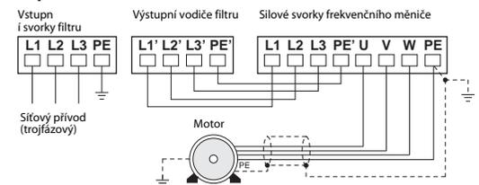
Vedení mezi frekvenčním měničem a motorem musí být kvůli snížení rušivého vyzařování ve stíněném provedení. Stínění motorového vedení je nutné na straně motoru a frekvenčního měniče provést velkoplošně.
