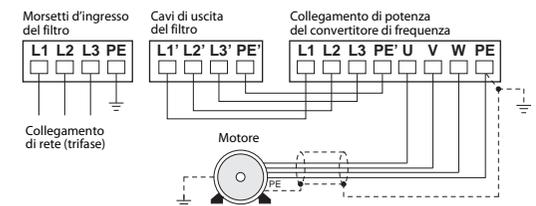
Per ridurre l'emissione di radiodisturbi, il cavo fra l'inverter e il motore deve essere schermato. Lo schermo del cavo motore deve essere collegato su entrambe e estremità con un'ampia superficie di contatto.
