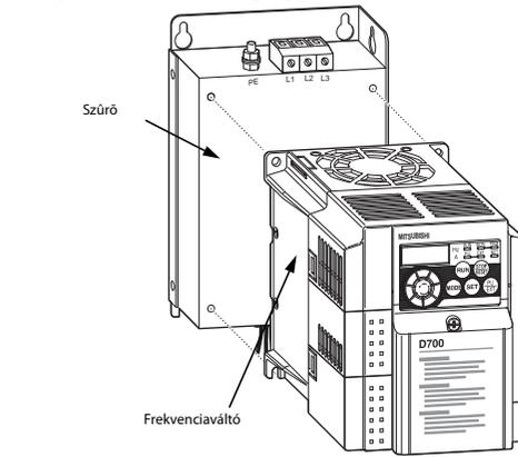
Rögzítse a szűrővel együtt a frekenciaváltót a vezérlőszekrény hátlapjához közönséges csavarok (nem mellélt tartozékok) segítségével. A szűrő megfelelő működéséhez a szűrőnek villamos kötésben kell lennie a vezérlőszekrény megfelelően földelt hátlapjával. Szükség esetén szedje le a festéket a szűrő talpairól.
