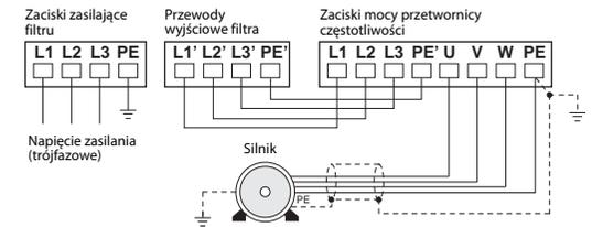
W celu zredukowania emisji zakłóceń, kabel ekranowany silnika musi być uziemiony na obu końcach.
