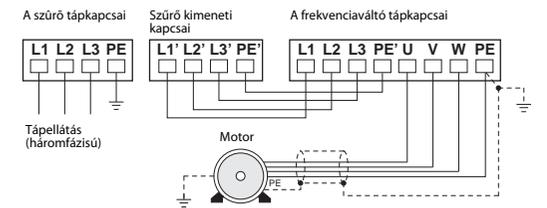
A sugárzott zavar csökkentéséhez az árnyékolt motorkábelt mindkét végén földelni kell.
